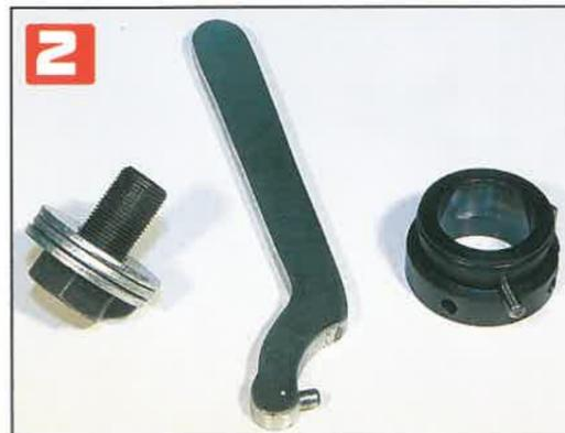
Voici l'appareil nécessaire à l'opération avec, à gauche, la vis plus longue que celle d'origine et ses trois rondelles ; au centre, la poignée qui permet de faire tourner le porte-burin (à droite).
