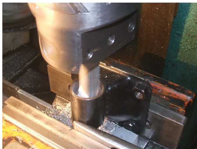
Alesage à la côte extérieure du roulement.
